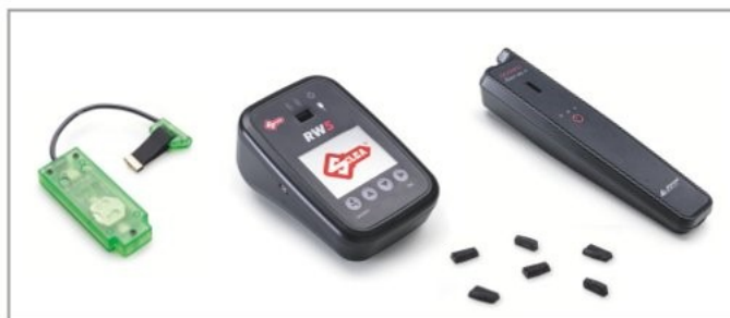
Clonage des véhicules Renault* et Dacia* ID49-1E à l'aide du R-Snoop et du Silca RW5 ou Smart Aerial+ avec un transpondeur GTI Pro ou UTX-S
