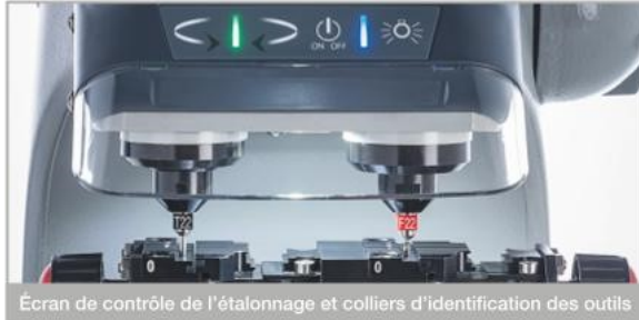
Écran de contrôle de l'étalonnage et colliers d'identification des outils
